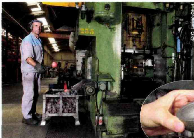
Les « lopins », cylindres de 430 grammes, sont chauffés à 1 000 degrés, écrasés en galettes, et frappés pour devenir une coquille, la moitié d'une boule de pétanque.
